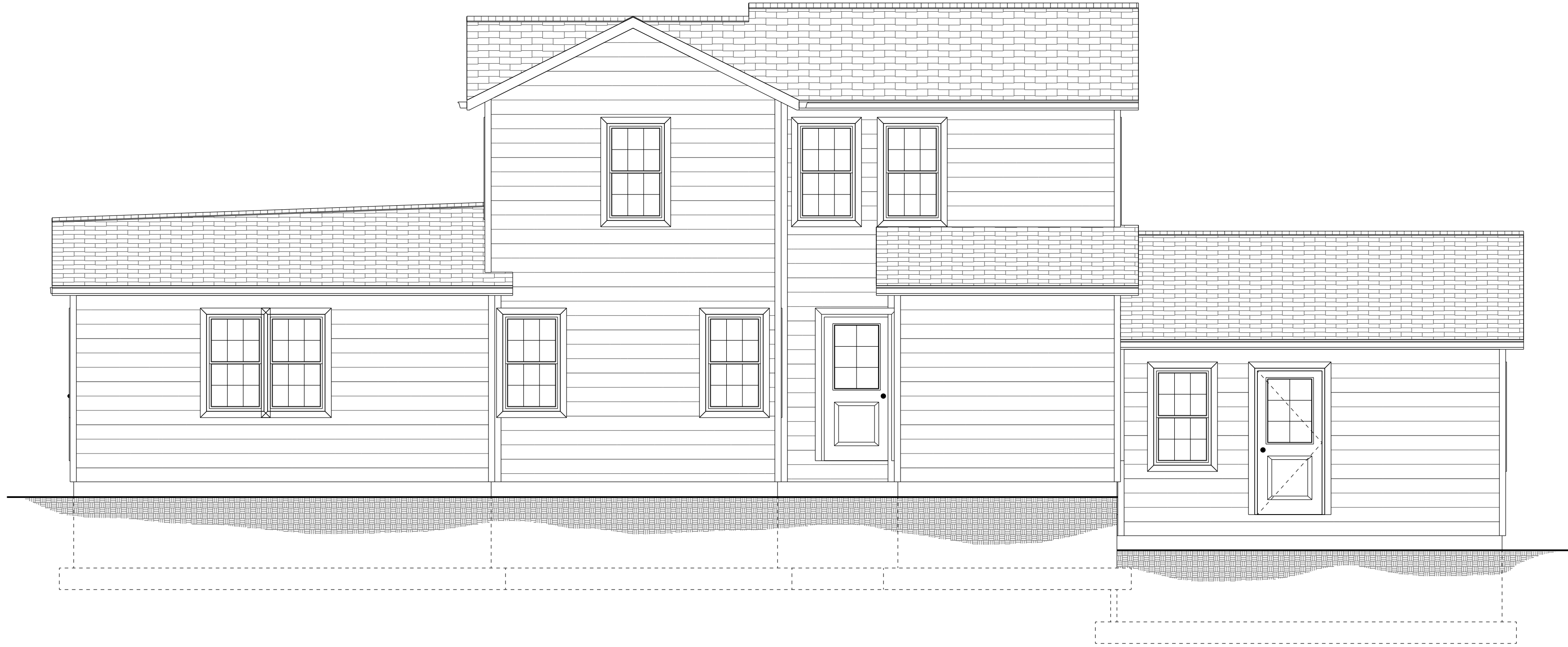
2 EXISTING LEFT ELEVATION A1 SCALE: 1/4" = 1'-0"
